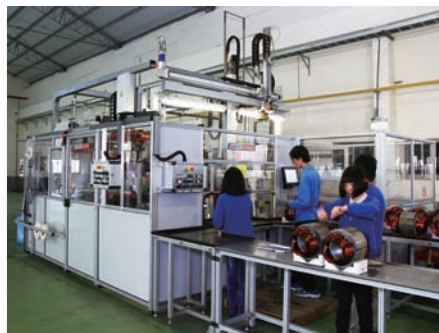
IE3モータ自動巻線/入線 /成形機と生産ライン IE3 Automatic motor Stator winding / Wedge Inserter / Coil Forming Machinery and Production Line
