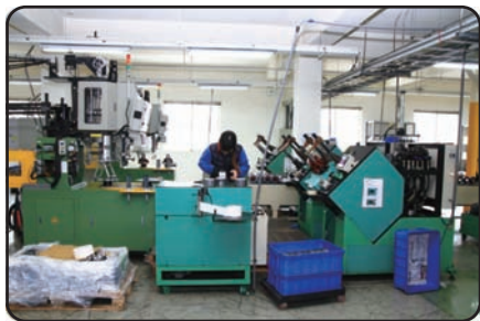
ストレートセットで巻線機 Vertical stator coil auto winding machine
