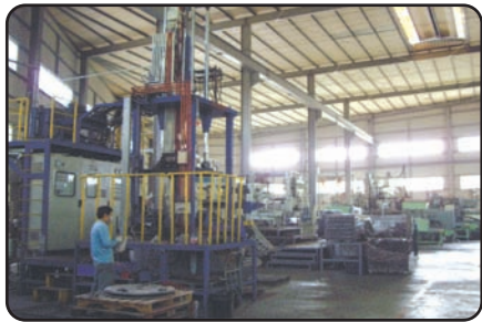
低圧鋳造機 Low Pressure Casting Machines
