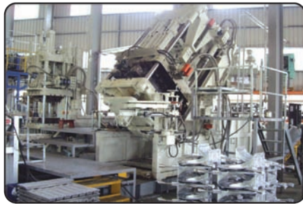
重力ダイキャストマシン Gravity Die Casting Machines
