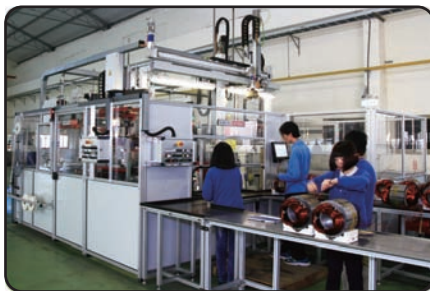
IE3モータ自動巻線/入線 /成形機と生産ライン IE3 Automatic motor Stator winding / Wedge Inserter / Coil Forming Machinery and Production Line
